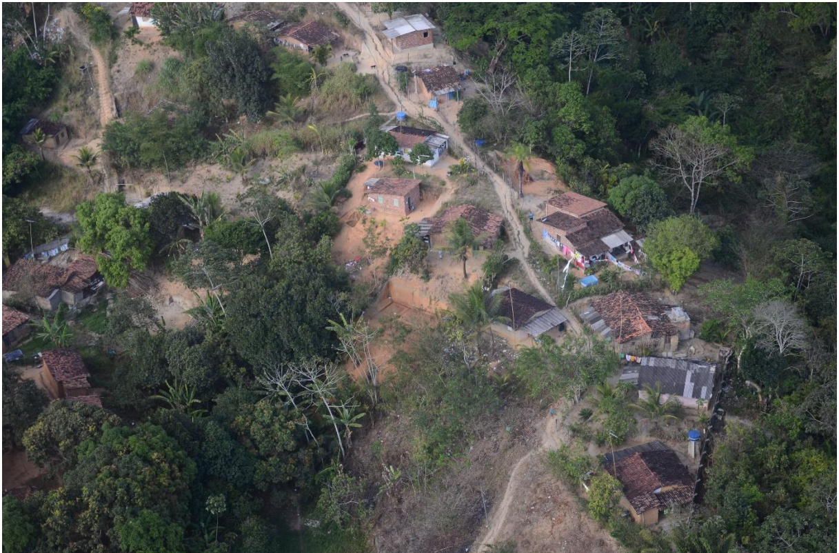
Figura 21 – Evidência de processos erosivos resultantes de ocupações não planejadas.
