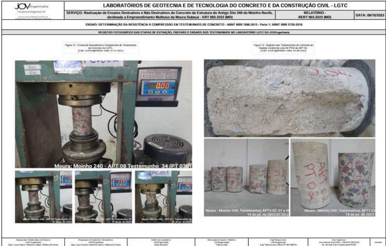
Figura 10: Ensaio de compressão nos corpos de prova extrídos dos Silos
