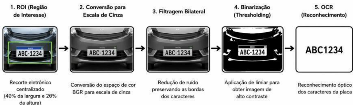
Figura 1 – Pipeline de processamento de imagem do sistema ALPR
