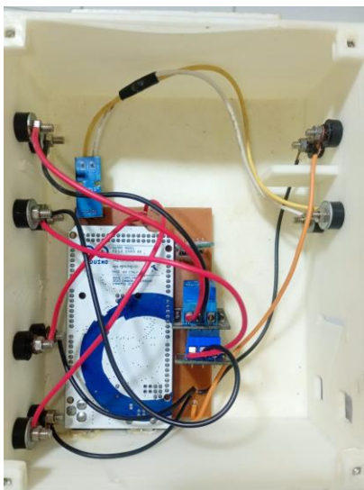
Figura 14 – Montagem na caixa do Chronos.
