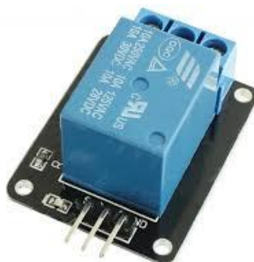
Figura 4 - Módulo de relé.
