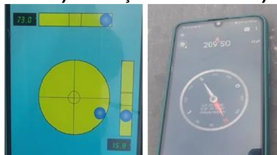
Figura 9 – Medição da: a) inclinação do coletor e b) azimute do coletor
