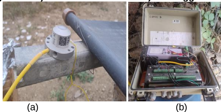
Figura 6 – a) Piranômetro SP-lite2 b) Datalogger CR-10X
