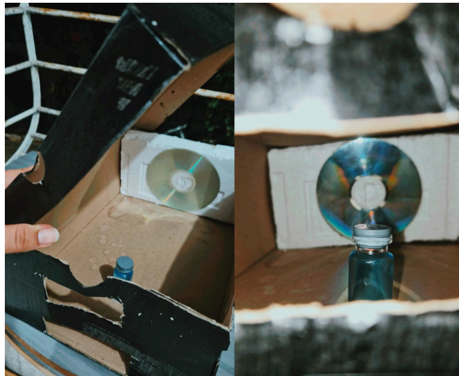
Imagem 4 - Câmara escura montada com caixa de papelão, cd e detergente.
