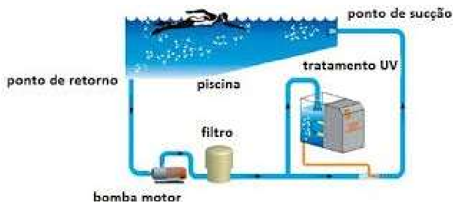
Figura 10. Esquema genérico do tratamento por UV.
