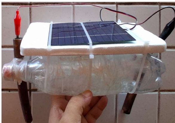
Figura 11. Protótipo de um ionizador solar.
