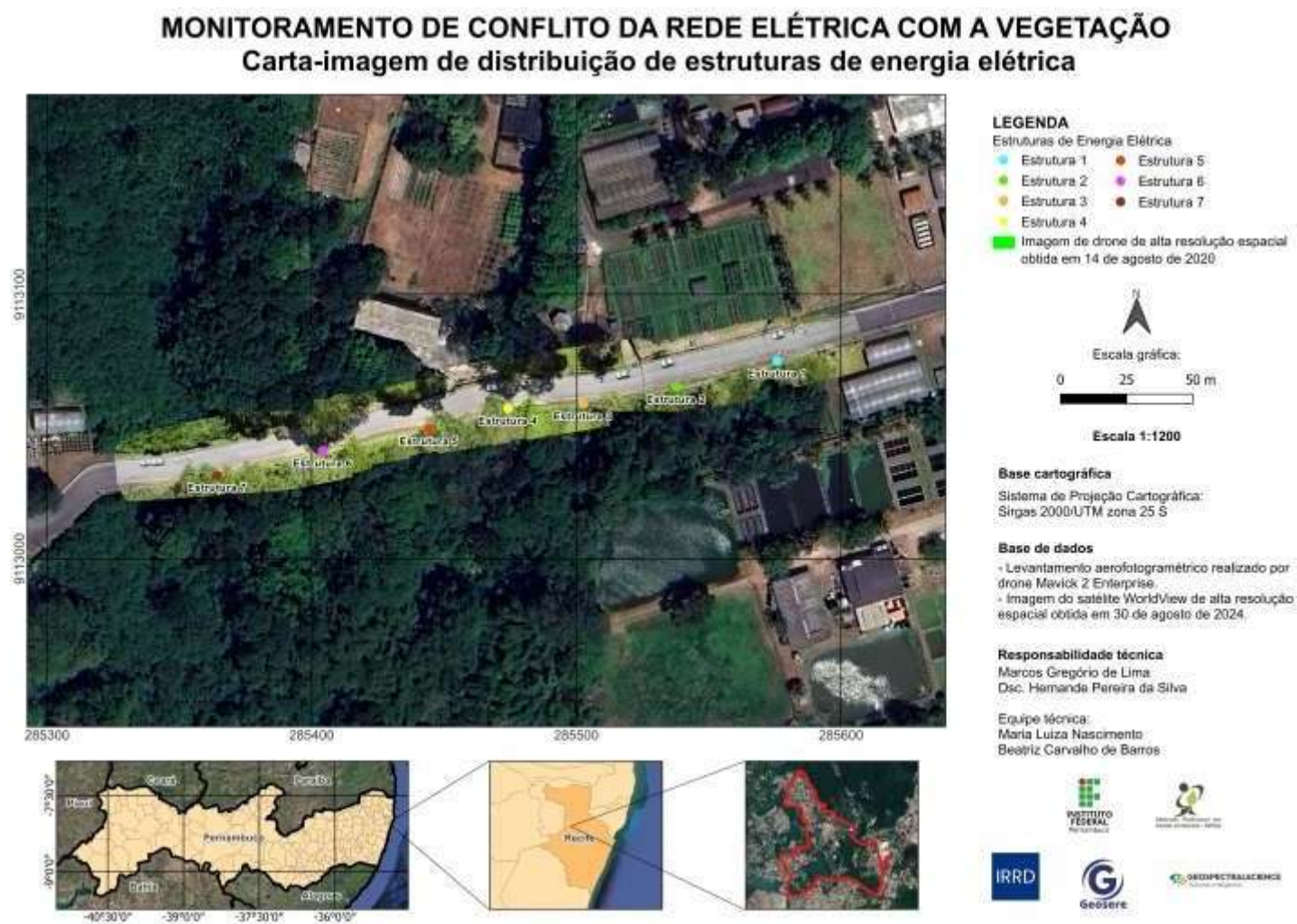
Imagem 23. Monitoramento de Conflito da rede elétrica com a vegetação. Estruturas (Vãos)
