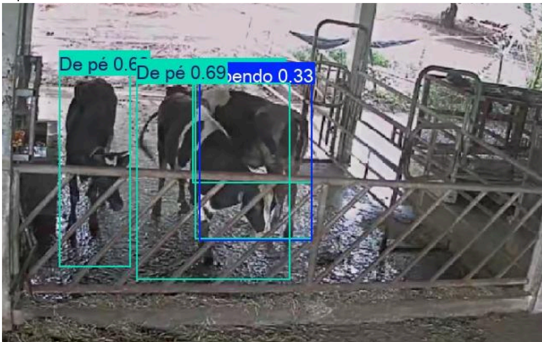
Figura 2. Exemplo de oclusão entre bovinos e aplicação da filtragem por confiança. A imagem mostra dois bovinos parcialmente sobrepostos, gerando múltiplas detecções. A filtragem top-K baseada na confiança permite eliminar predições de baixa confiabilidade, mantendo apenas as mais precisas.
