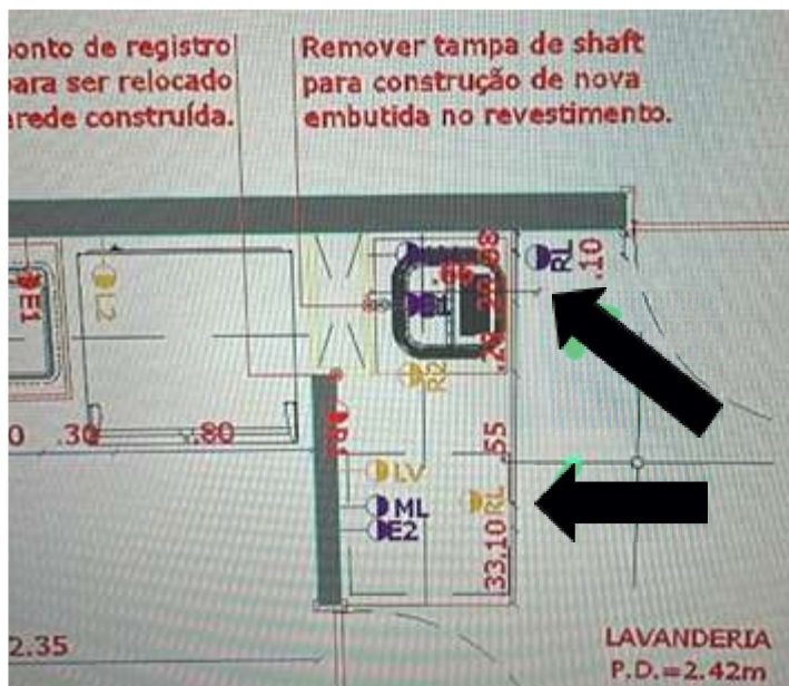
Figura 6 – Projeto indicando alteração significativa de ralo de piso posteriormente reavaliada.
