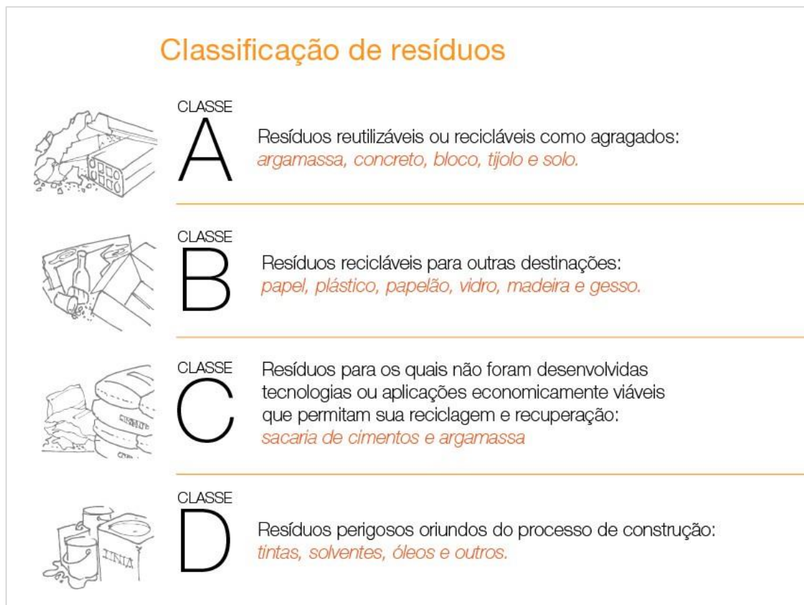
Figura 9. Classificação dos resíduos de construção civil segundo a Resolução CONAMA 307/2002
