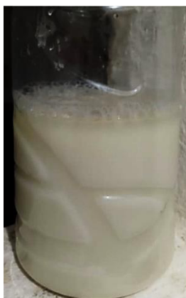
Figura 7 – Líquido em repouso para decantação
