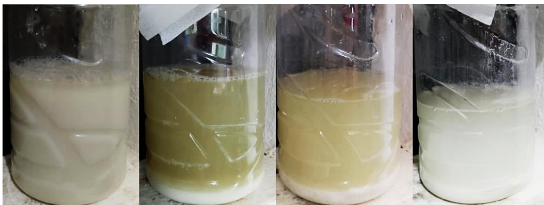
Figura 16 – Fases da decantação e purificação do amido da fruta-pão
