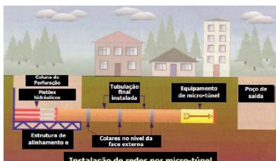
Figura 5: Instalação de redes por micro túnel (Fonte: Abratt, 2004).
