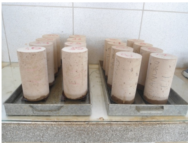
Figura 7.14 – Ensaio de Absorção por Capilaridade
