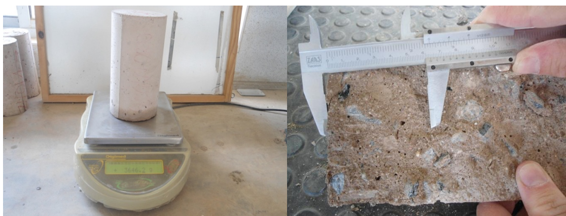
Figura 7.15 – Ensaio de Absorção por Capilaridade: (a) pesagem após absorção de água e (b) determinação da ascensão capilar
