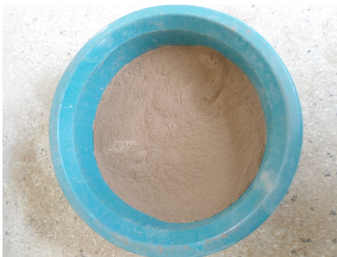
Figura 6.5 – Aspecto da CLE obtido após tratamento – material passante na peneira #200
