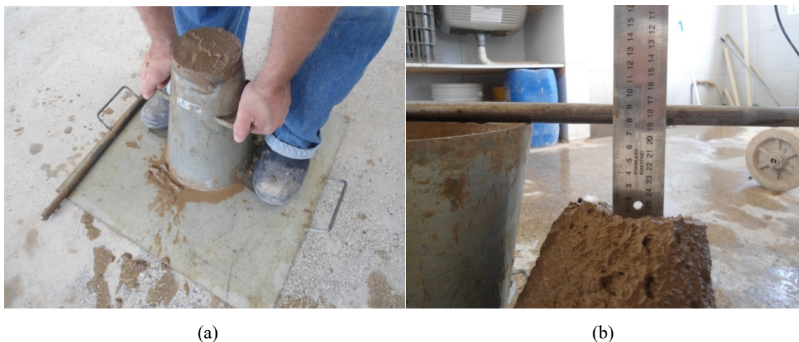
Figura 7.7 – Ensaio de Abatimento do Tronco de Cone para determinação da Trabalhabilidade:
