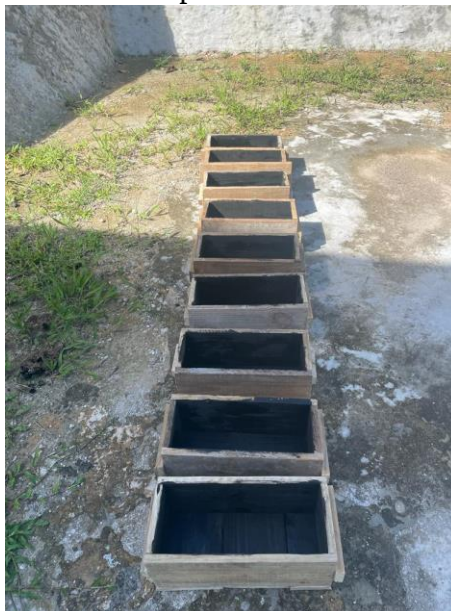
Figura 14 - Fôrmas de madeira plastificada e untadas com óleo mineral
