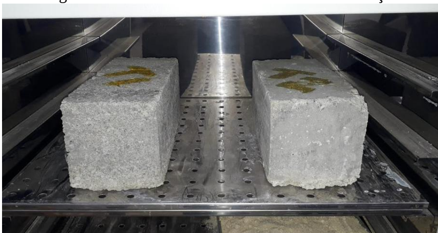
Figura 18 - Blocos de concreto em ensaio de absorção
