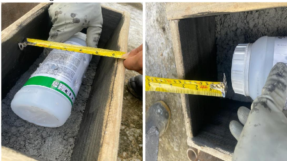
Figura 15 - Dimensões internas do bloco de concreto.
