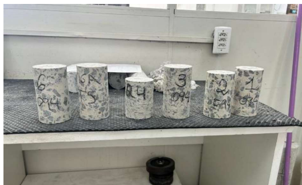
Figura 12 – Testemunhos devidamente tratados no laboratório
