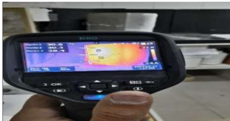
Figura 23 – Ensaio de termografia infravermelha durante o resfriamento do prisma
