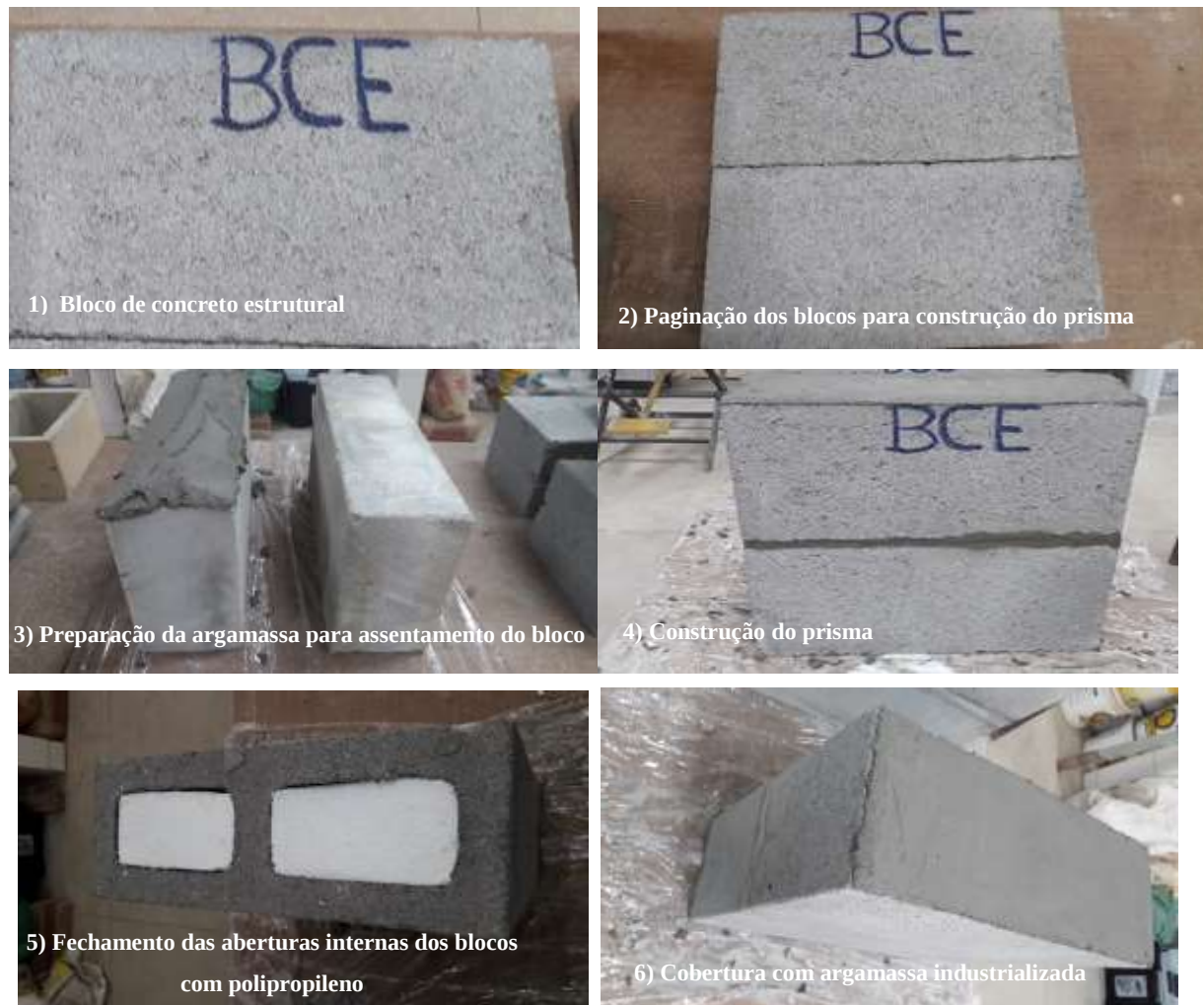
Figura 11 – Construção do prisma de blocos de concreto estrutural- BCE
