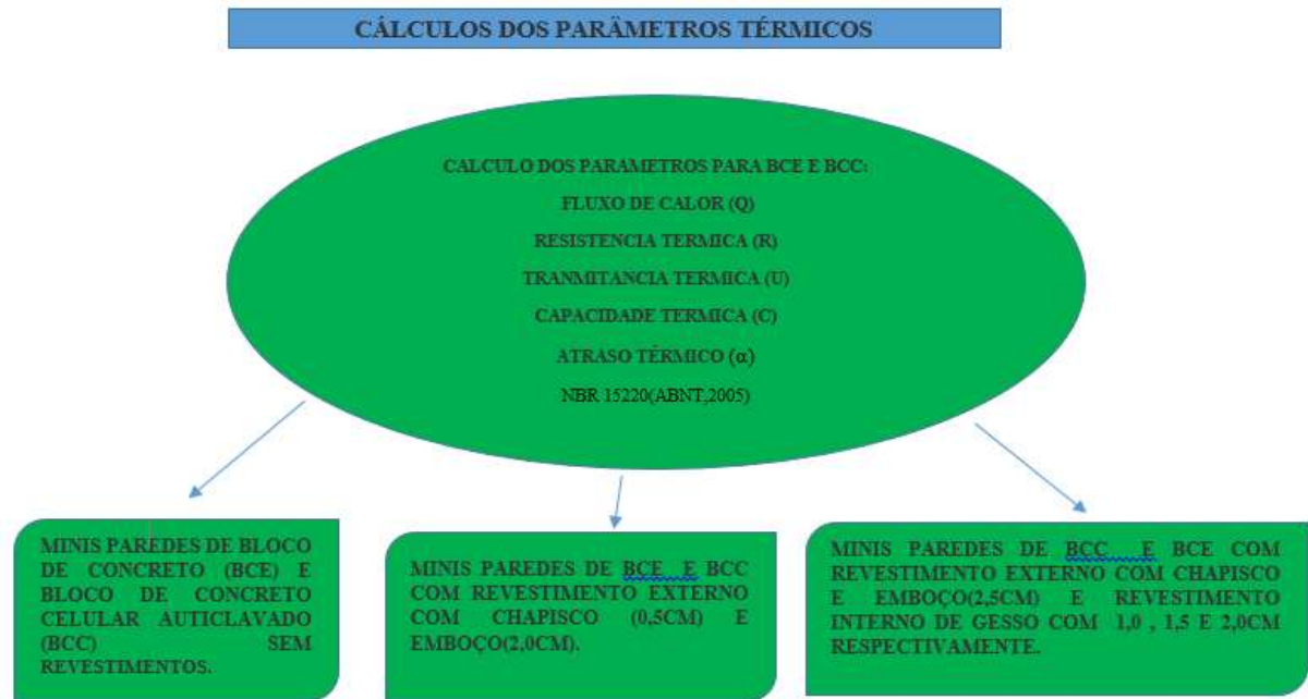
Figura 24 – Fluxo dos cálculos dos parâmetros térmicos – NBR 15220
