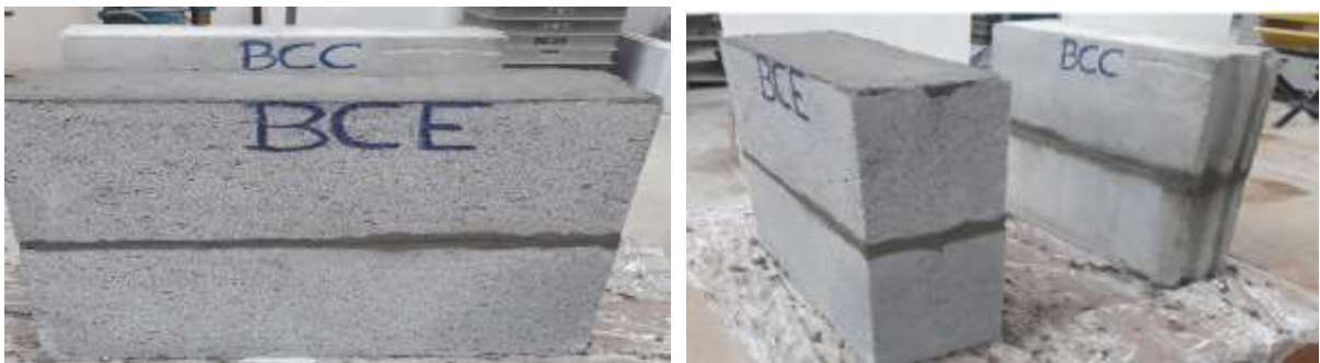
Figura 13 – Prisma dos blocos de concreto estrutural-BCE e de concreto celular maciço-BCC
