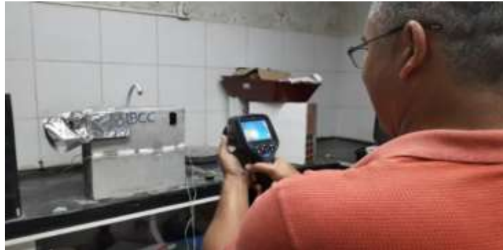
Figura 22 – Método da fita preta para determinação da emissividade
