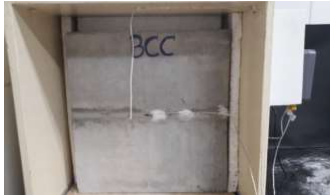
Figura 18 – Vista do ensaio na câmara térmica com a prisma BCC
