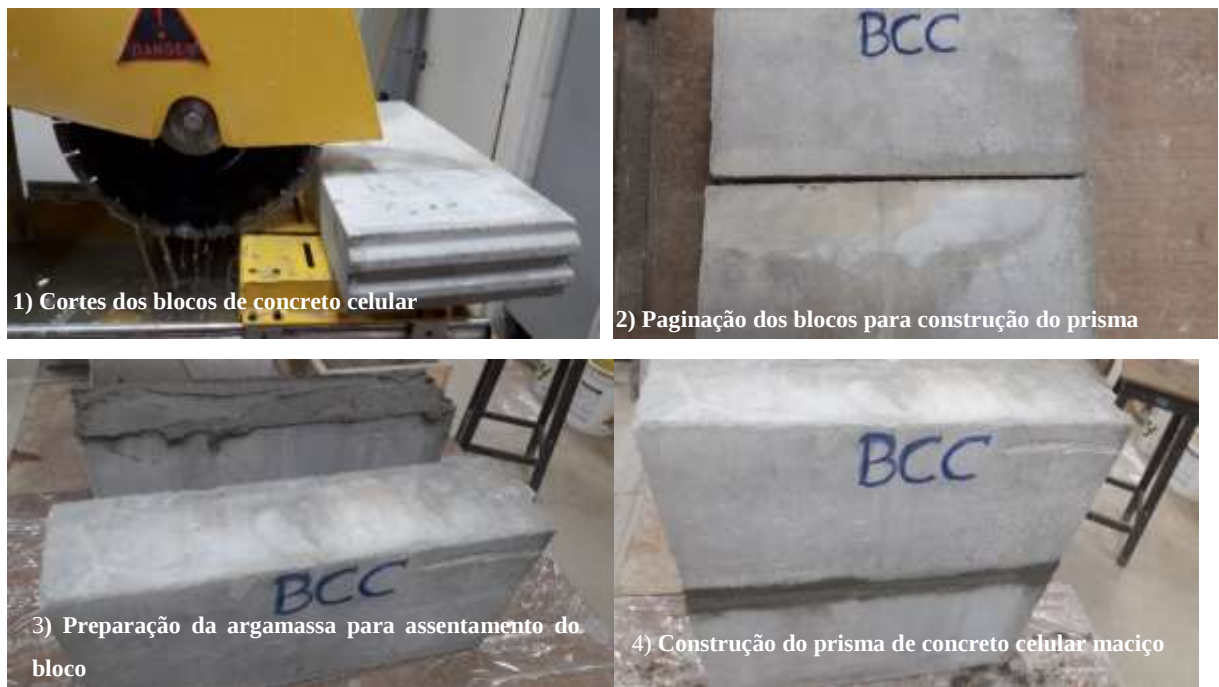
Figura 12 – Construção do prisma de blocos de concreto celular maciço- BCC
