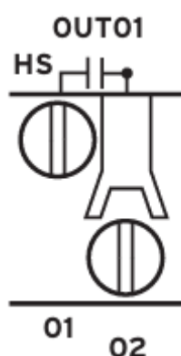
Figura 13: representação da saída de alta velocidade e interrupção dos relés digitais Sel.
