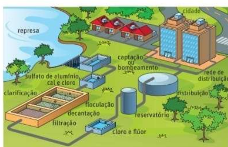
Esquema dos processos utilizados para o tratamento da água. Representação fora de escala e em cores-fantasia.
