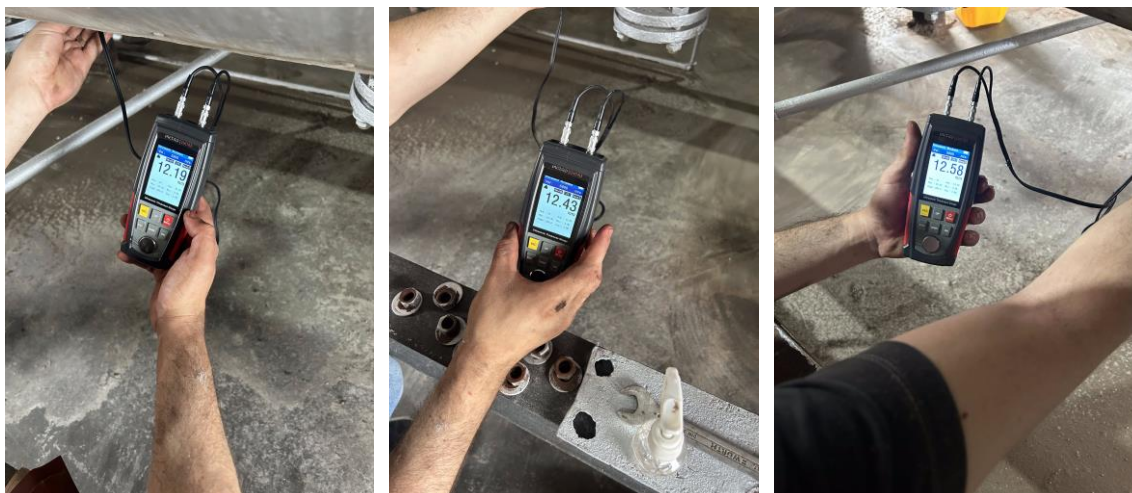
Figura 3.19. Medições de espessura no costado da caldeira. Fonte: Autoria Própria (2023).
