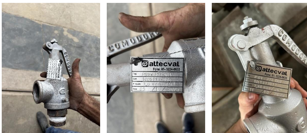
Figura 3.12. Uma das válvulas de segurança (à esquerda) e placas de identificação das duas válvulas. Fonte: Autoria Própria (2023)
