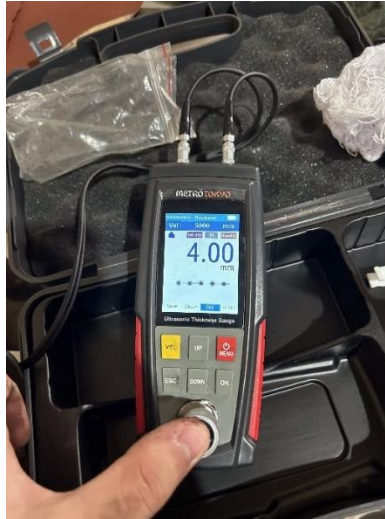
Figura 2.5. Procedimento de auto calibração do medidor de espessura. Fonte: Autoria Própria (2023).
