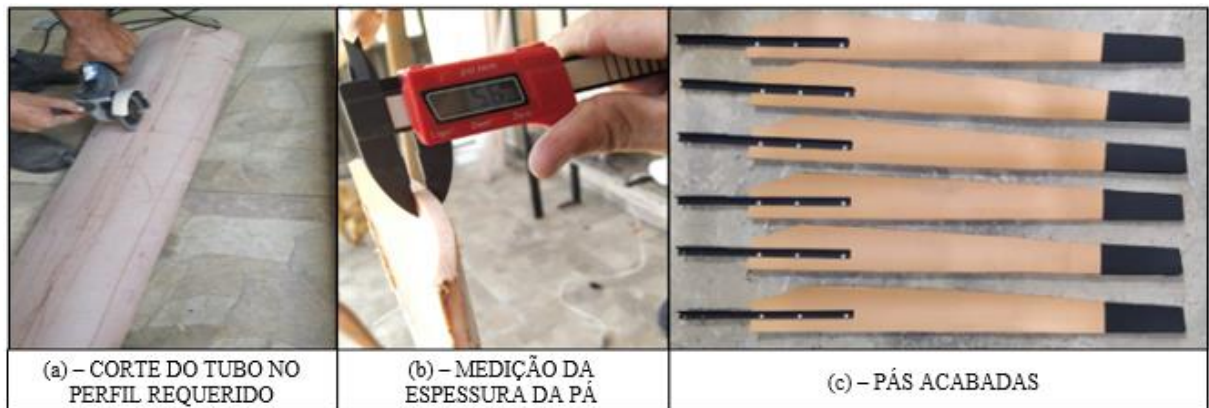
Figura 13. Processo de confecção das pás da turbina
