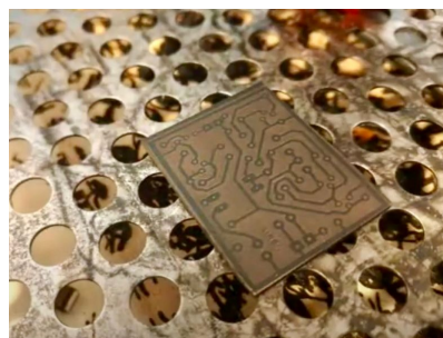
(b) PCI após exposição e transferência do design eletrônico.
