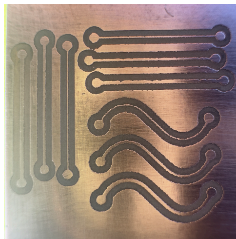
(b) Potência 50%, velocidade 800 mm/min e 12.000 linhas/mm, gravação vertical.
