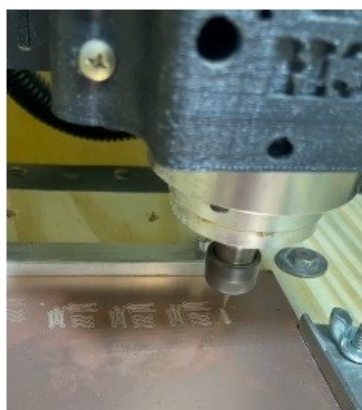
Figura 15 – Testes de usinagem sendo realizados na placa de cobre.
