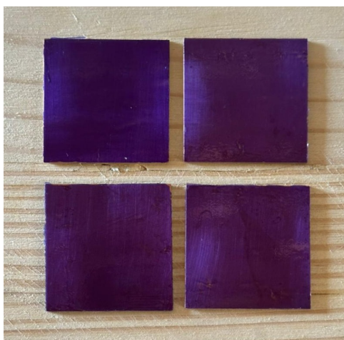
Figura 6 – Aplicação do dry film.
