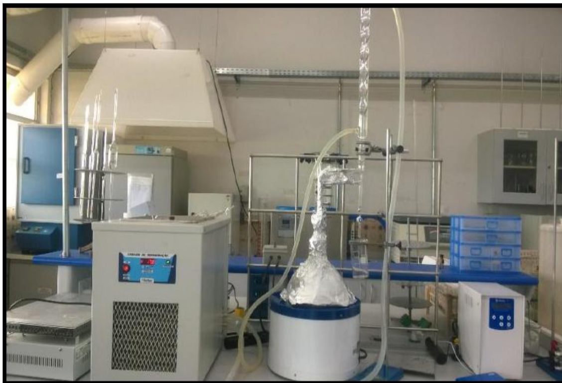
Figura 4 Sistema Clevenger modificado para obtenção do óleo essencial
