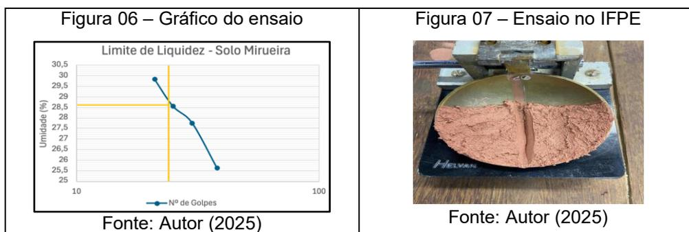
3.2.1.2 - A determinação do Limite de Liquidez (LL), foi realizada pelo aparelho de Casagrande (Figura 07) conforme a NBR 6459:2016 e gerou os dados da tabela da Figura 08, e através de resultado gráfico, relacionado ao cruzamento de retas perpendiculares do teor de umidade e da posição de 25 Golpes, descrito na Figura 06, apresentou resultado de 28,5% e está dentro da margem aceitável da NBR 10833, que recomenda os valores menores que de 45% para esse parâmetro.
