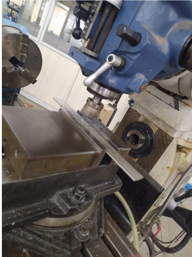
Figura 14. Esquema para fresagem dos corpos de prova na primeira etapa
