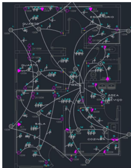
Figura 6 – Distribuição dos eletrodutos e fios
