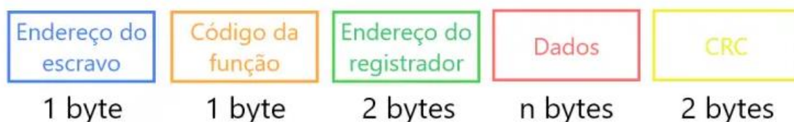
Figura 2.9 - Modelo de mensagem Modbus RTU
