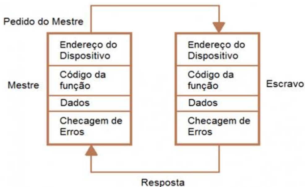
Figura 2.8 - Modelo de mensagens Modbus.
