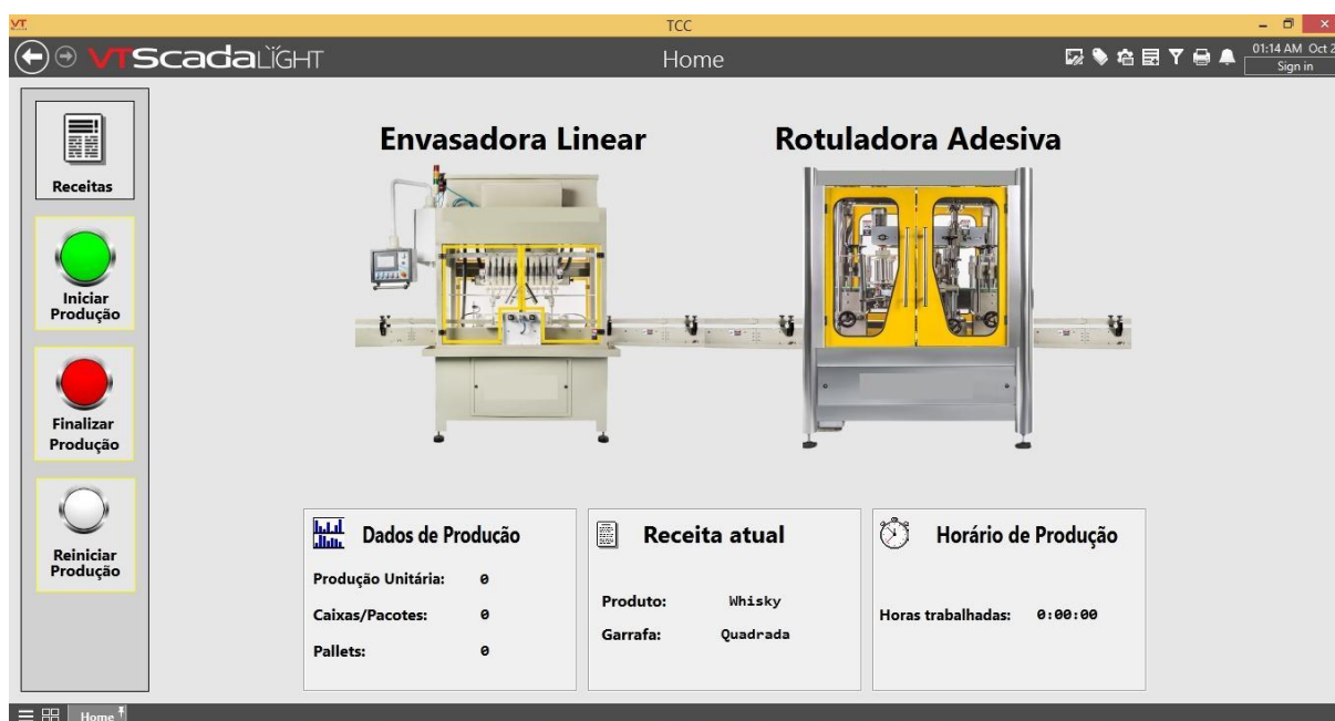
Figura 4.4 - Tela principal do supervisório.
