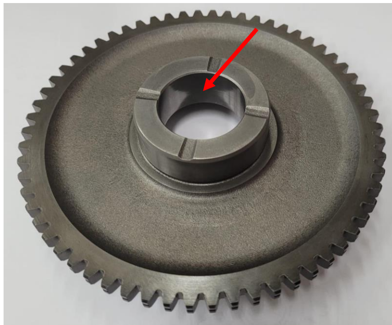
Figura 4 - Engrenagem Movida de Partida com Falha de material
