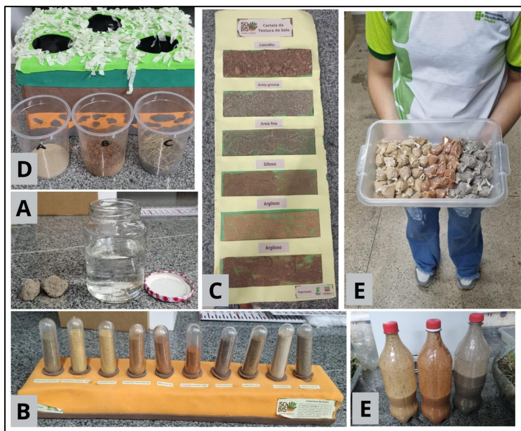
Figura 5 - Experimentos utilizados para o conceito de características do solo com os estudantes do ensino médio e fundamental. 5A - Experimento Porosidade do solo, 5B - Experimento Colorteca, 5C- Cartela de Textura, 5D - Caixa sensorial, 6E - Kit tinta com solos
