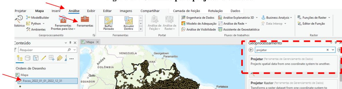
Em seguida preencha qual camada será projetada (Focos) e escolha a coordenada que será utilizada SIRGAS 2000. Clique em executar. Uma nova camada será criada, assim, a camada que está com a coordenada WGS 1984 pode ser excluída do projeto.
