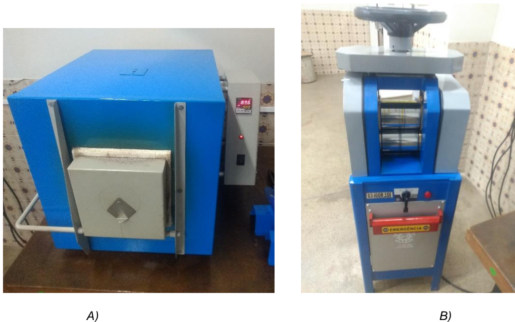
Figura 16 - Laboratório de Tratamento térmico IFPE Recife. A) Forno; B) Laminador.
